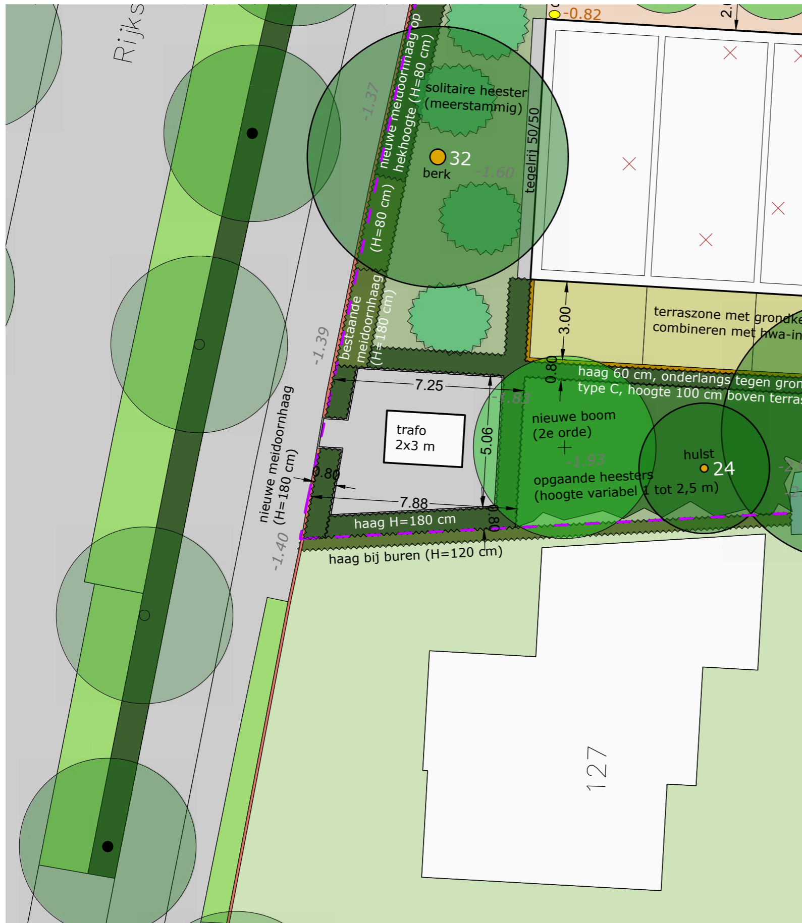
inpassing trafo aan stoepszijde Rijksstraatweg, in hoek kavel, omzoomd met een haag, uit het zicht
